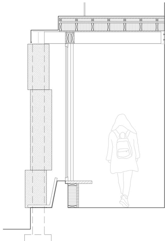
SEZIONE COSTRUTTIVA NUOVA COSTRUZIONE CORTE INTERNA 1:20
